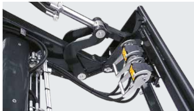
Hydro-Fix fås også til redskabsmontering til endnu hurtigere forbindelse af de hydrauliske ledninger.
